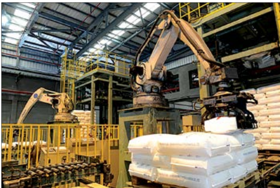
▲ Robot tự động bốc xếp hạt nhựa Polypropylen - Công nghiệp 4.0 tại NMLD Dung Quất
